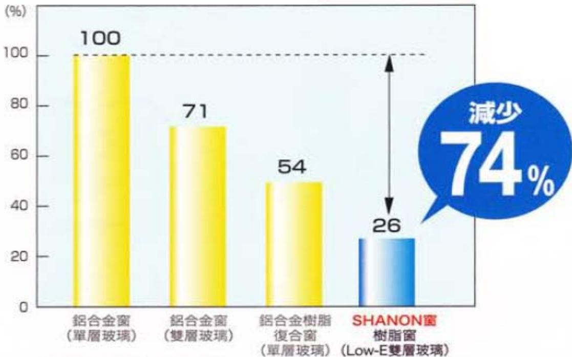
圖 3-4 塑鋼框與鋁框搭配不同玻璃之熱得分析
